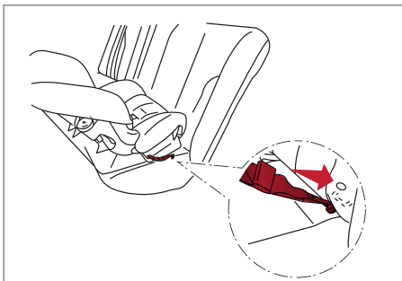
Fijación tipo gancho de enganche orientado hacia atrás - paso 2
